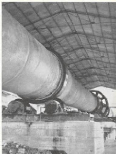
Il forno rotante, lungo 90 metri, della cementeria.
